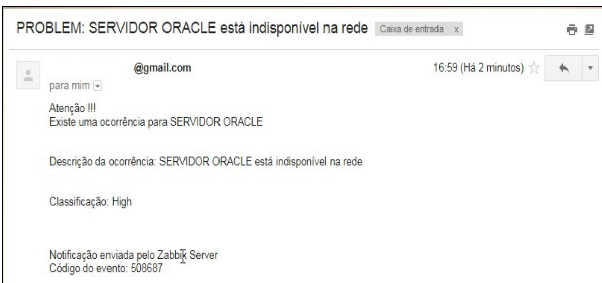
Figura 10. Alerta de indisponibilidade enviado por e-mail ao administrador de redes. (Do Autor).
