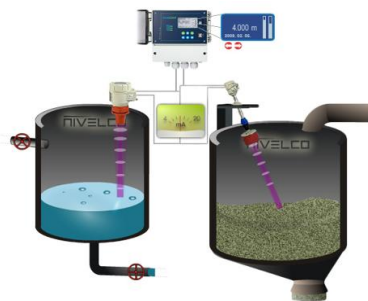
Figura 4. Modelo de funcionamento de Sensor Ultrassônico
