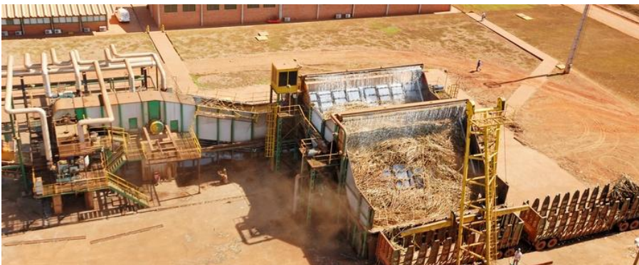
Figura 2. Mesa alimentadora em funcionamento
