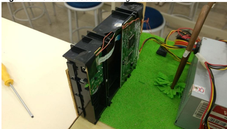
Figura 8. Portão simulado com um gravador de CD/DVD
