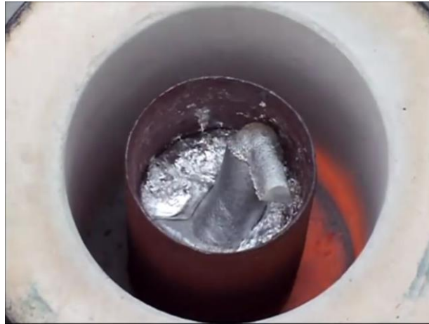
Figura 04: Derretimento de alumínio no forno portátil
