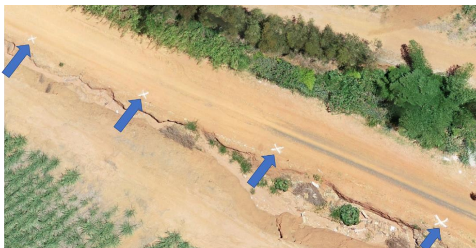
Figura 3 - Detalhe dos pontos de apoio materializados no solo
