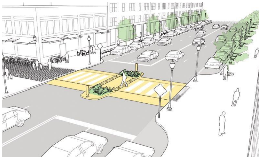
FIGURA 6 – Representação de travessia elevada para pedestres
