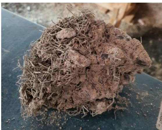
FIGURA 5 – Segregação encontrada em corpo de prova do T IV
