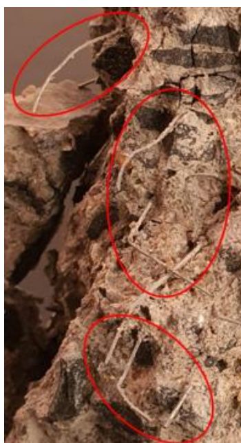
FIGURA 7 – Fibras deformadas após rompimento
